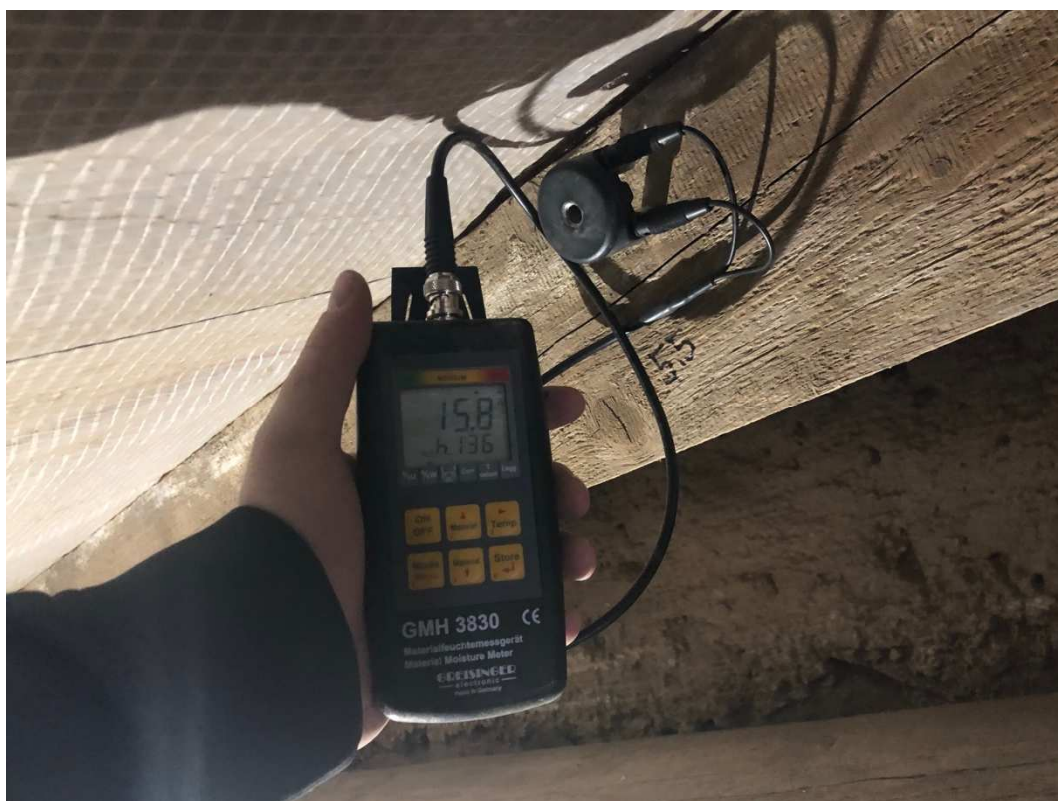
Foto č. 20 Měření vlhkosti bodu 5.5 (27.3.2021)
