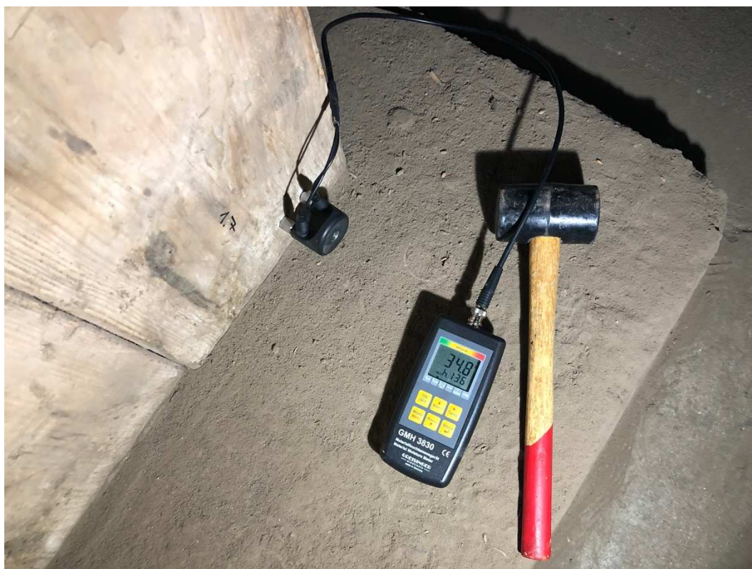
Foto č. 36 Měření vlhkosti bodu 1.7 (1.4.2021)
