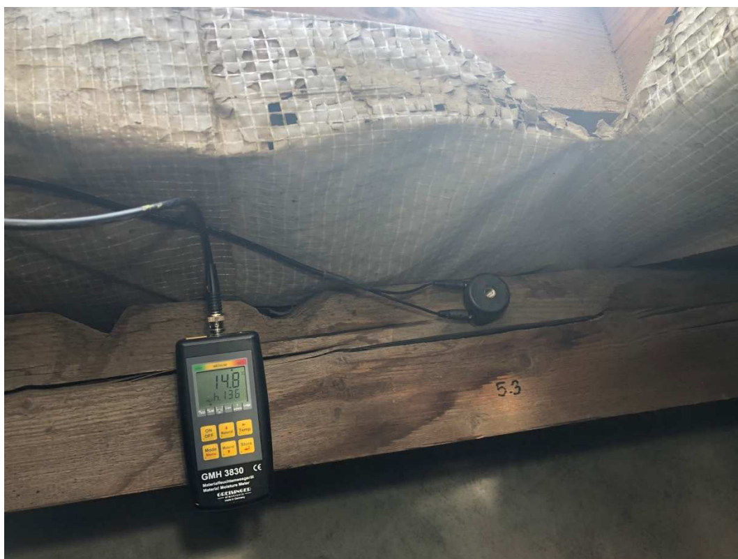
Foto č. 18 Měření vlhkosti bodu 5.3 (27.3.2021)
