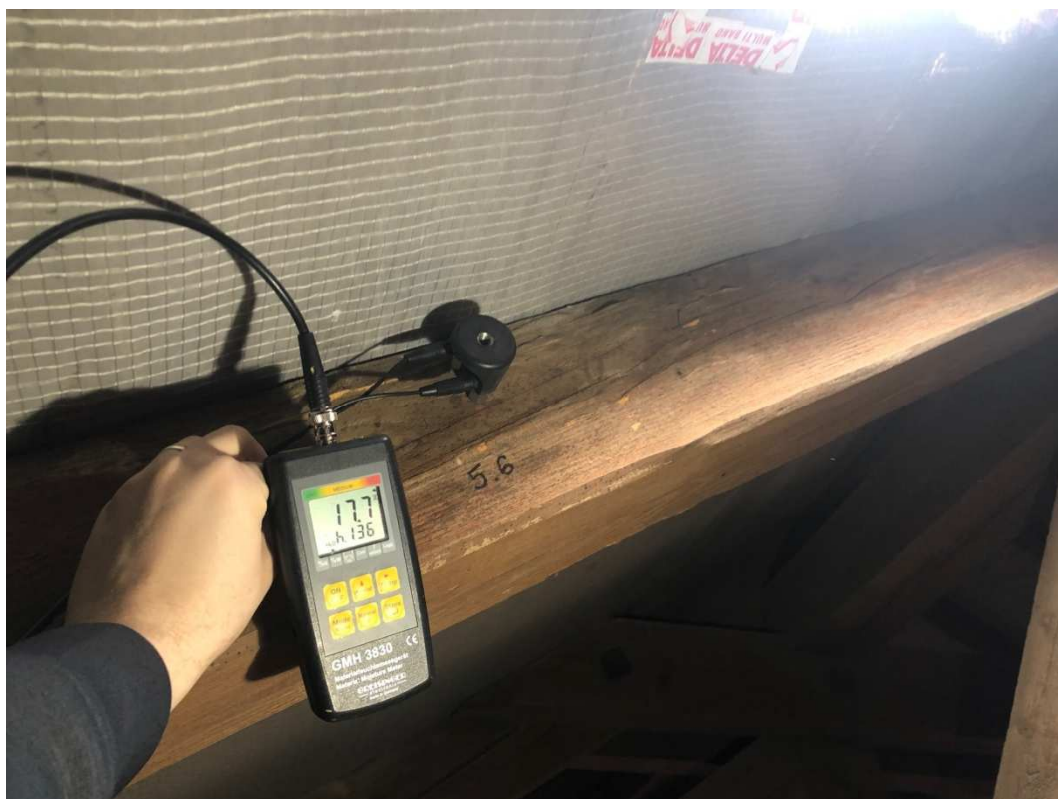
Foto č. 21 Měření vlhkosti bodu 5.6 (27.3.2021)
