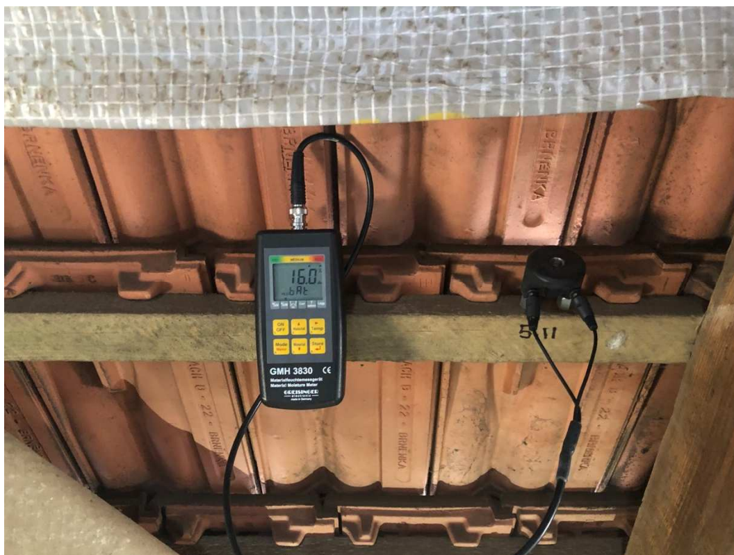
Foto č. 25 Měření vlhkosti bodu 5.11 (27.3.2021)
