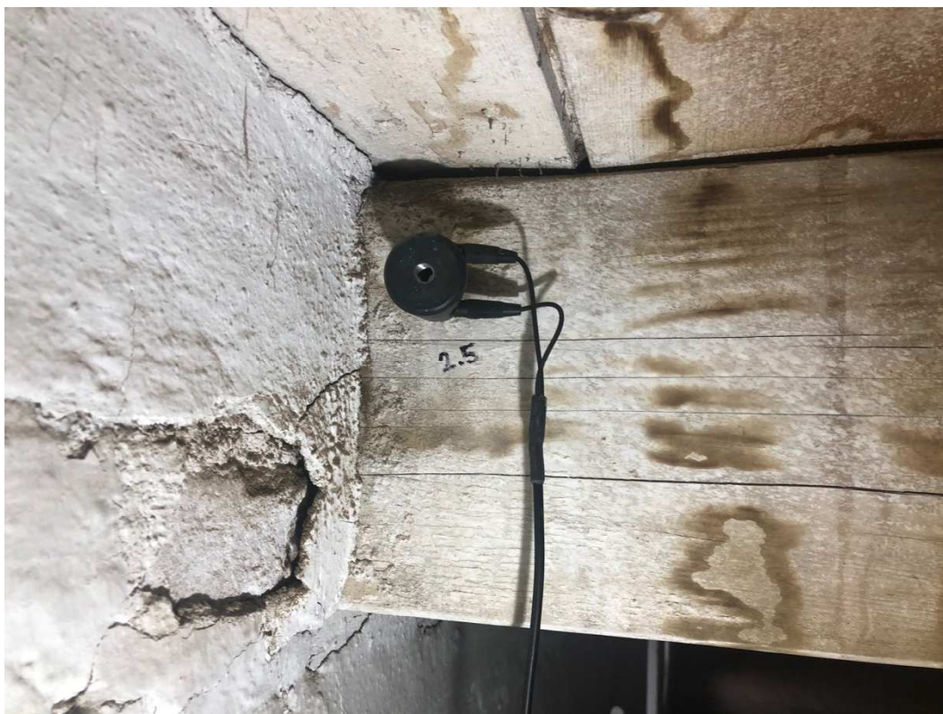
Foto č. 10 Měření vlhkosti bodu 2.5 (27.3.2021)
