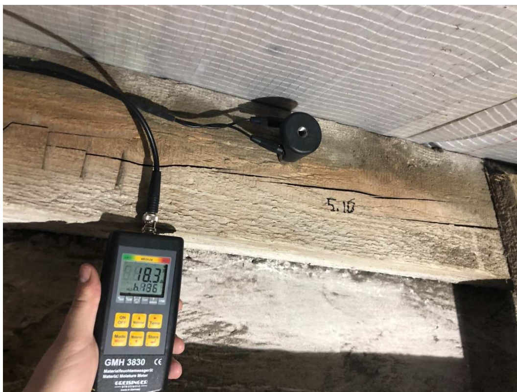
Foto č. 24 Měření vlhkosti bodu 5.10 (27.3.2021)
