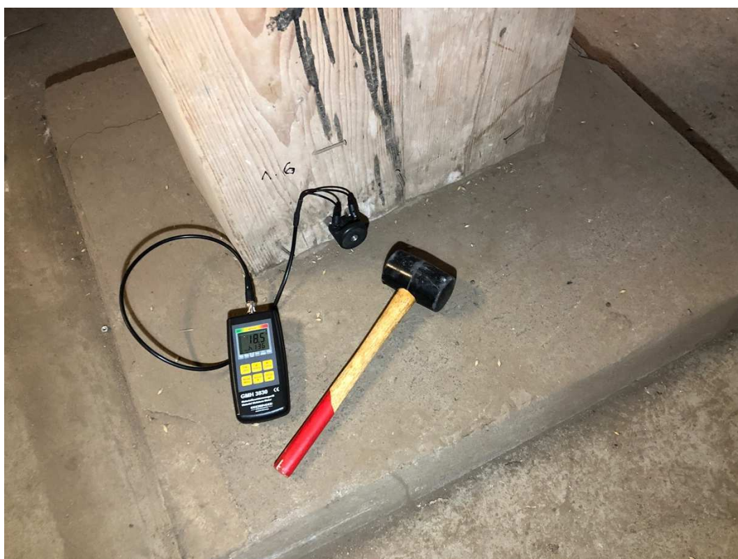
Foto č. 35 Měření vlhkosti bodu 1.6 (1.4.2021)
