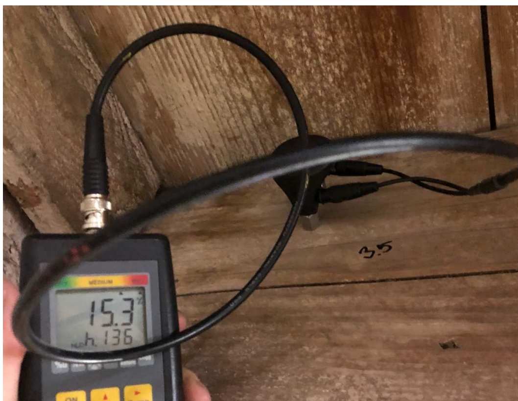
Foto č. 33 Měření vlhkosti bodu 3.5 (1.4.2021)
