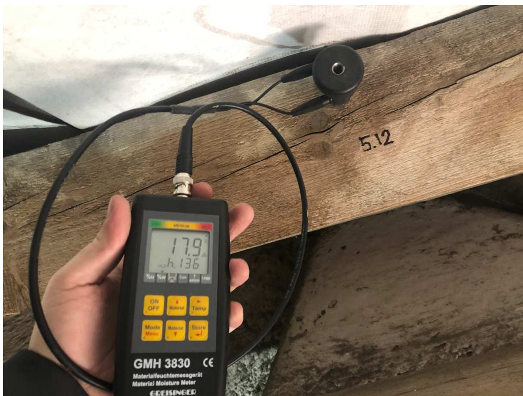
Foto č. 26 Měření vlhkosti bodu 5.12 (27.3.2021)
