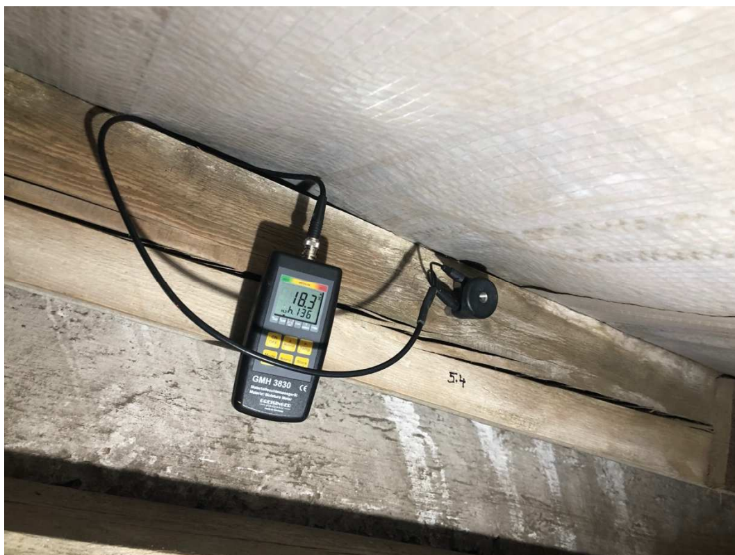
Foto č. 19 Měření vlhkosti bodu 5.4 (27.3.2021)
