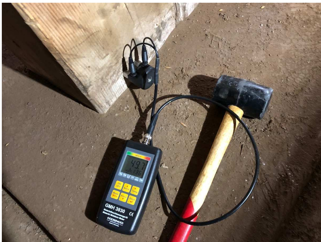
Foto č. 34 Měření vlhkosti bodu 1.1 (1.4.2021)
