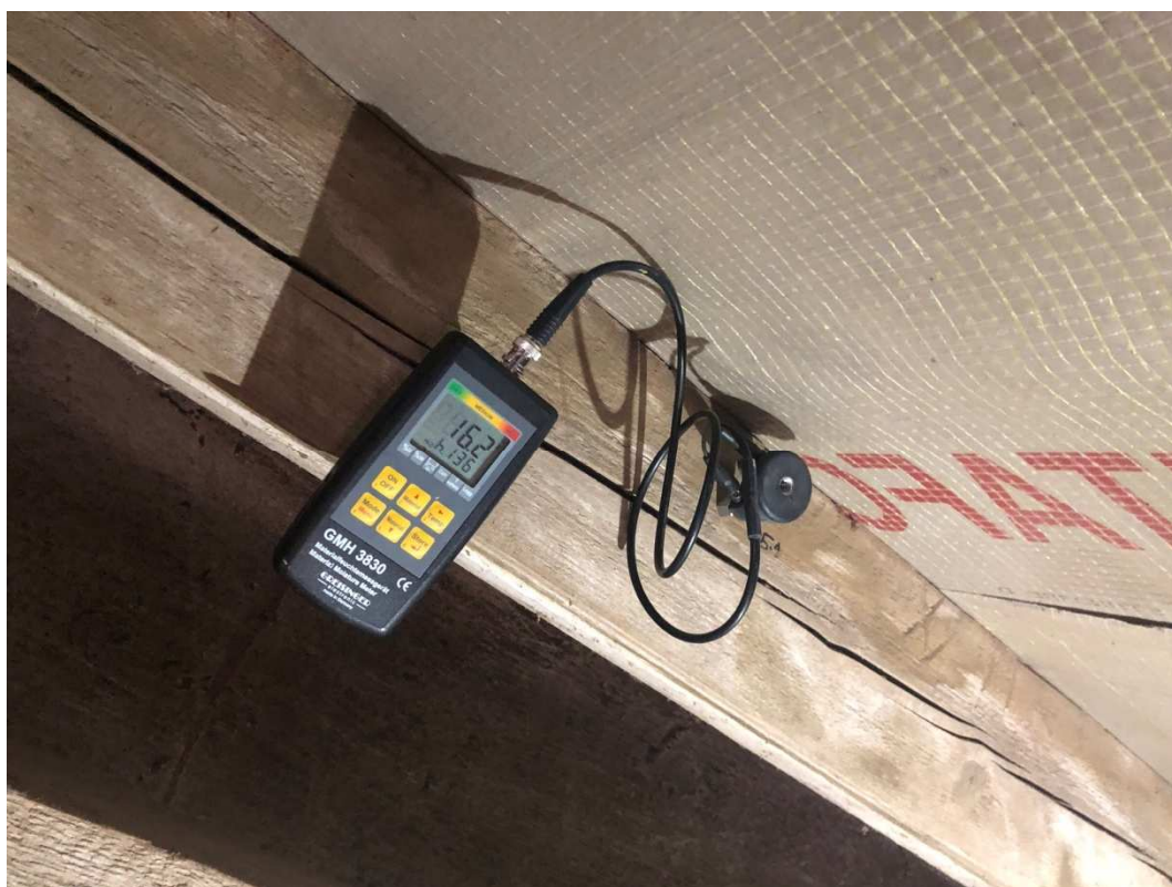
Foto č. 16 Měření vlhkosti bodu 5.1 (27.3.2021)
