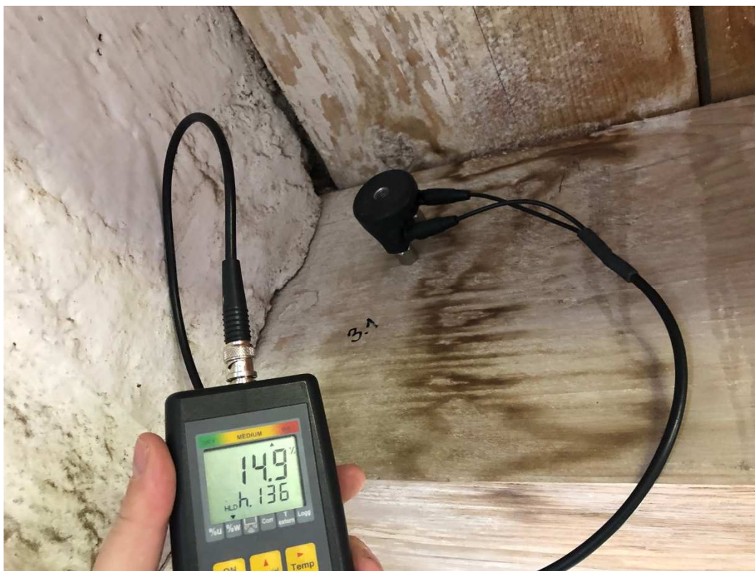
Foto č. 29 Měření vlhkosti bodu 3.1 (1.4.2021)
