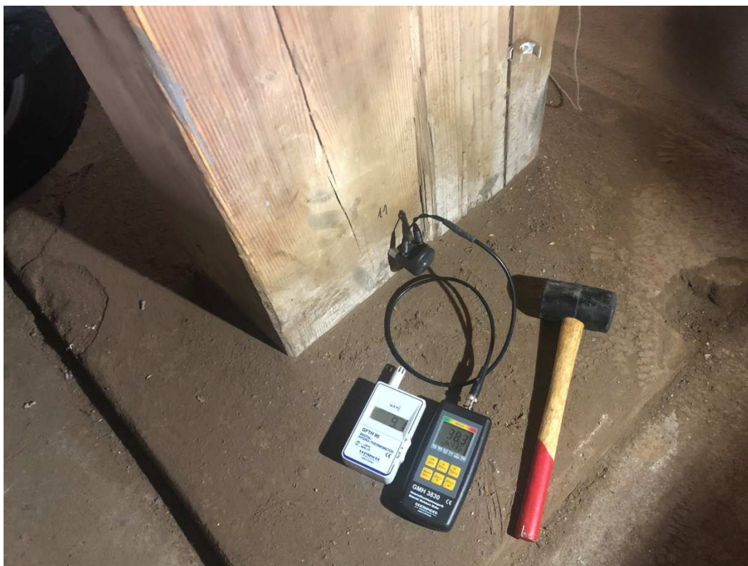
Foto č. 1 Měření vlhkosti bodu 1.1 (27.3.2021)
