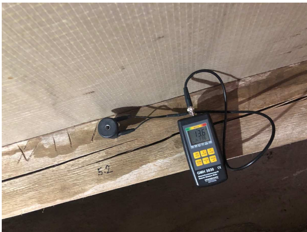
Foto č. 17 Měření vlhkosti bodu 5.2 (27.3.2021)
