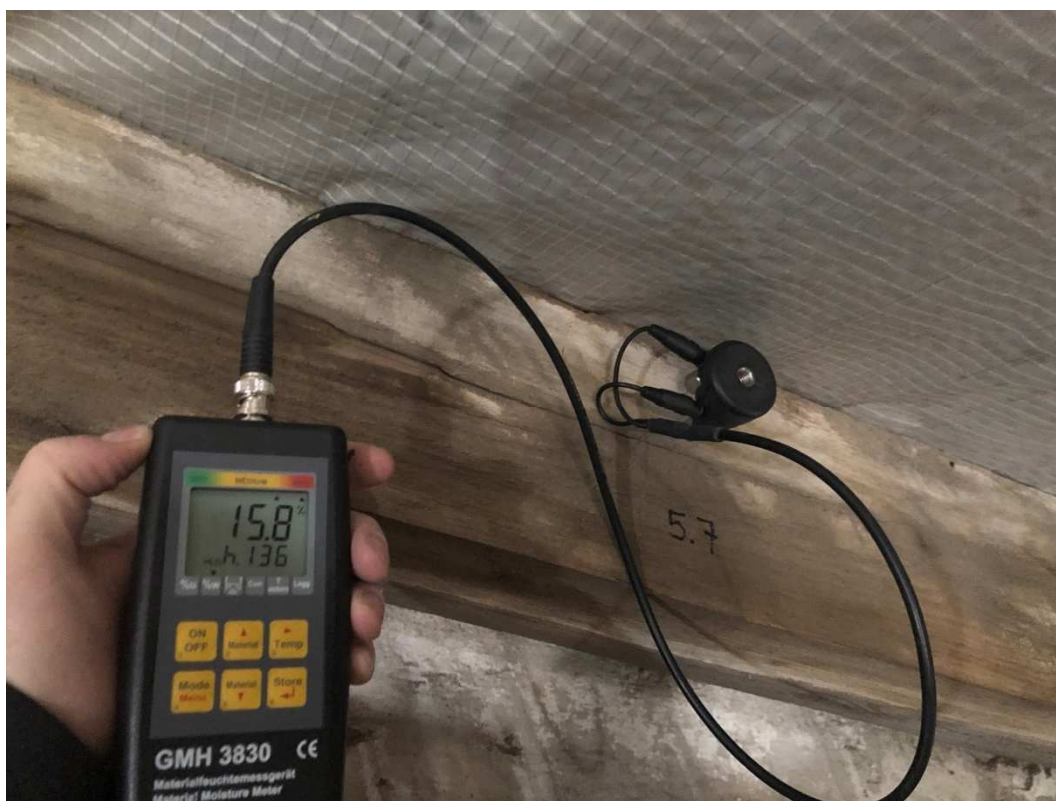
Foto č. 22 Měření vlhkosti bodu 5.7 (27.3.2021)
