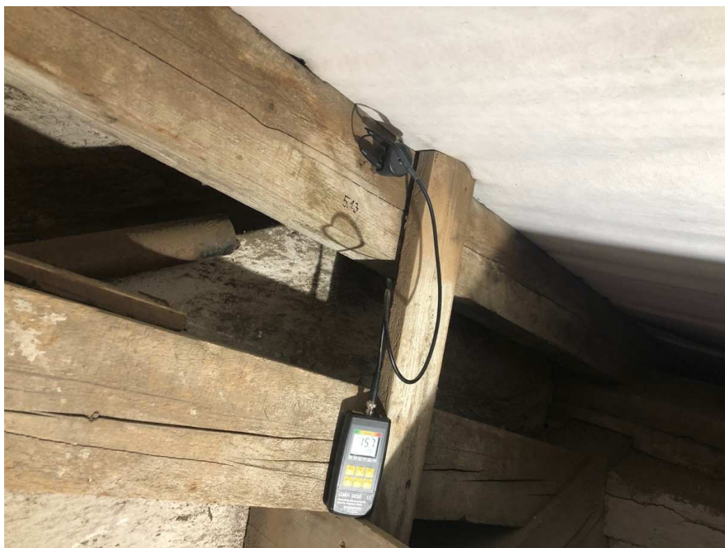
Foto č. 27 Měření vlhkosti bodu 5.13 (27.3.2021)
