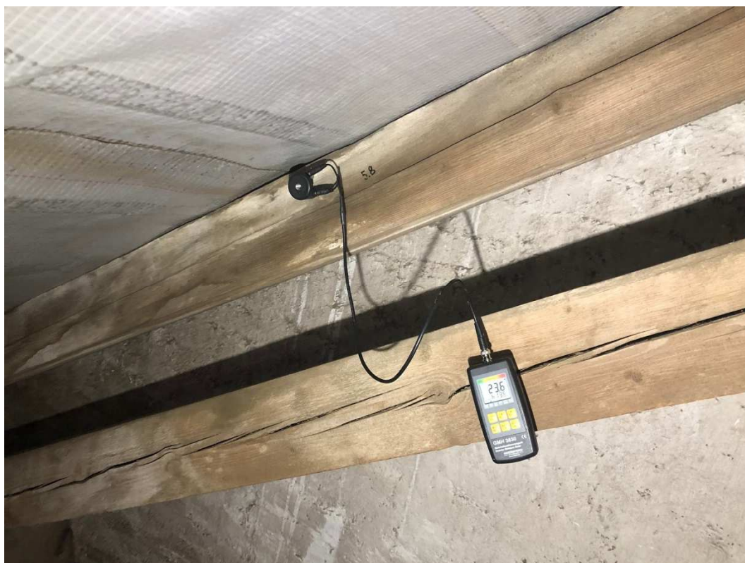
Foto č. 23 Měření vlhkosti bodu 5.8 (27.3.2021)
